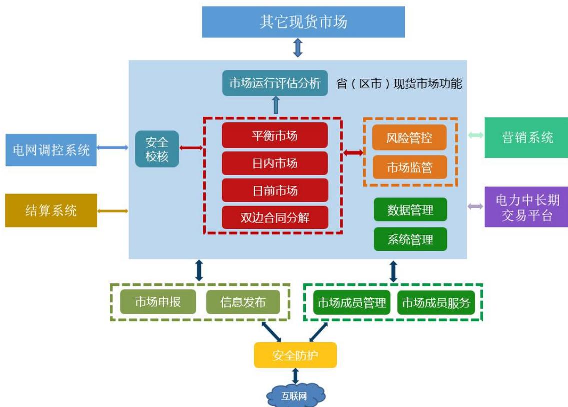
图 1 分散式电力市场运营系统现货交易功能逻辑结构示意图
